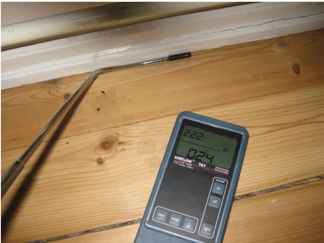
Foto 8: Eksempel på lufthastighedsmåling 0,24 m/s ved utæthed mellem gulv og fodpanelets fejlliste ved 50 Pa
