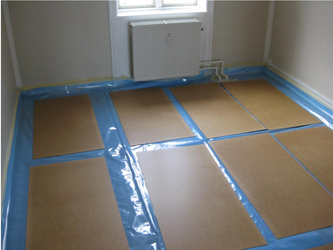
Foto 3: Der udlægges masonitplader som ballast og til at simulere lamelbrædder eller væg til væg tæppe
