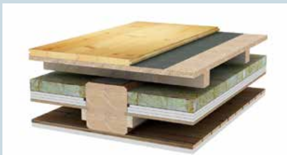
Bærende gulv på gulvstrøer på tværs af bjælker
