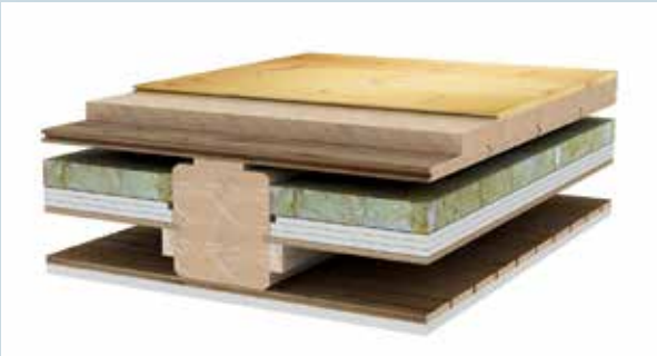
Svømmende gulv på træfiberunderlag på nye eller genudlagte gulvbrædder
