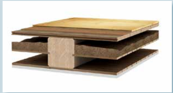
Svømmende gulv på korkunderlag på eksisterende gulv
