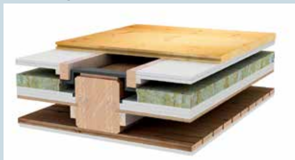
Bærende gulv på stålbeslag eller hattebeslag
