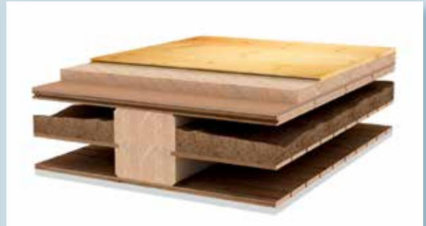
Svømmende gulv på træfiberunderlag på eksisterende gulvbrædder
