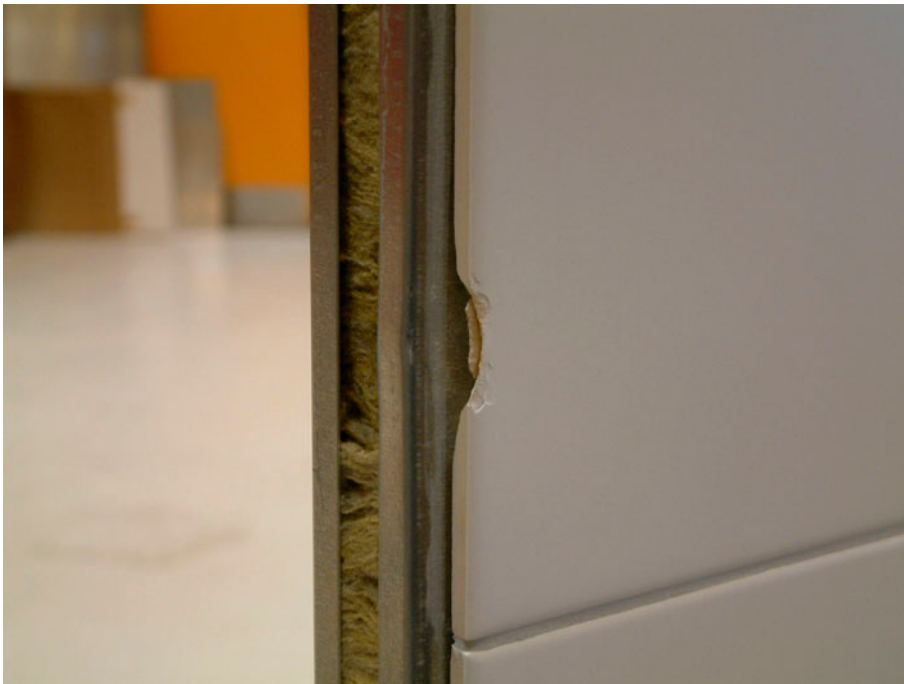
Figur 14. Flise på kant af element efter stød med kugle (15 Nm).
