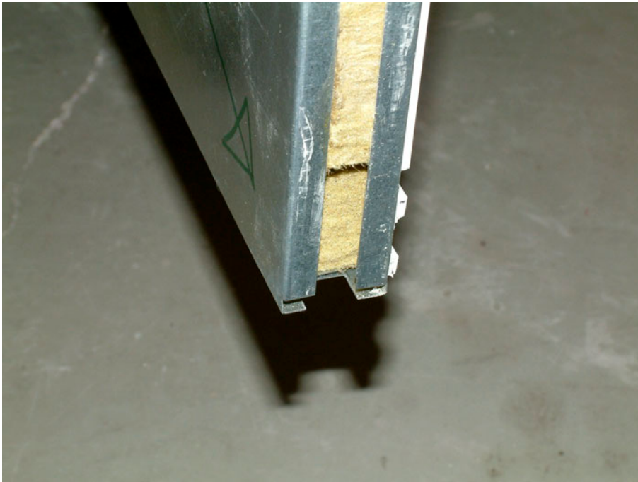
Figur 12. Hjørne på vægelement efter stød mod gulv.
