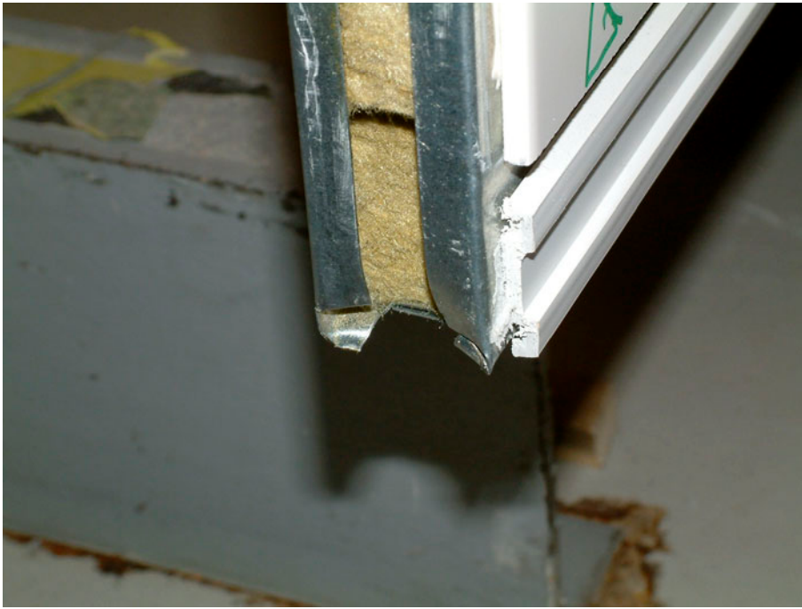
Figur 13. Hjørne af vægelement efter dynamisk stød med kugle (10 Nm).
