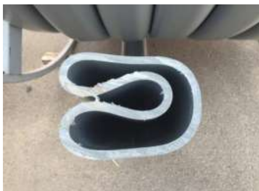
Figur 6.11. Stram foring hvor rørets tværsnit er foldet sammen under produktionen
