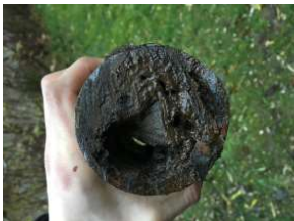
Figur 7.4. I køkkenfaldstammer er der ofte mange aflejringer
