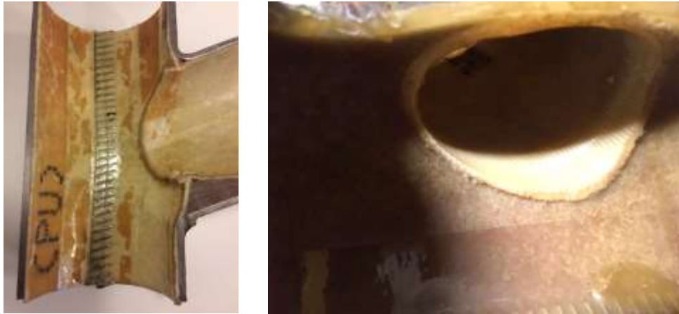
Figur 6.10. Tilslutning af sidegren til faldstamme med kantlimning
