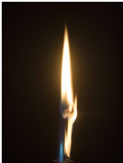
Figur 2. Polyethylen drypper som stearinlys i kontakt med en flamme (Shashoua, 2008).
