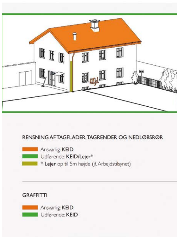
Figur 29: Illustration fra publikationen Snitflader for vedligehold – Opgavefordeling mellem Københavns Ejendomme og de kommunale lejere i kommunale lejemål . (Københavns Ejendomme)
