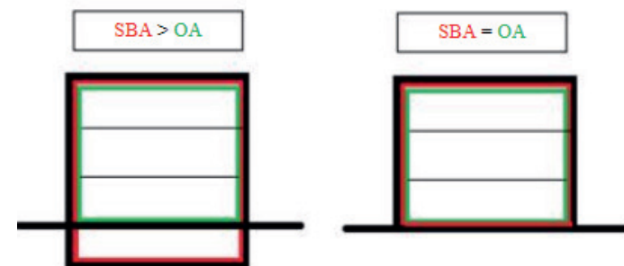
Figur 2 Eksempler hvor SBA er større end OA og SBA = OA (kilde: DGNB DK manual for boliger og etageejendomme)
