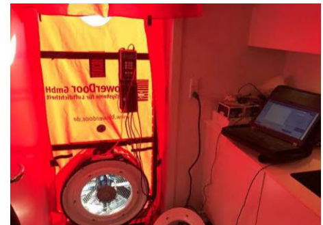
Blowerdoor set indefra.
