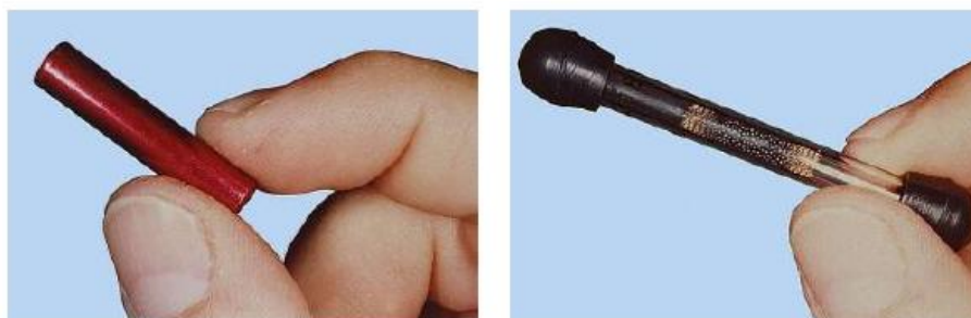
Figur 7.8: Figur til venstre viser sporgaskilde, og figur til højre viser adsorptionsrør/6/.
