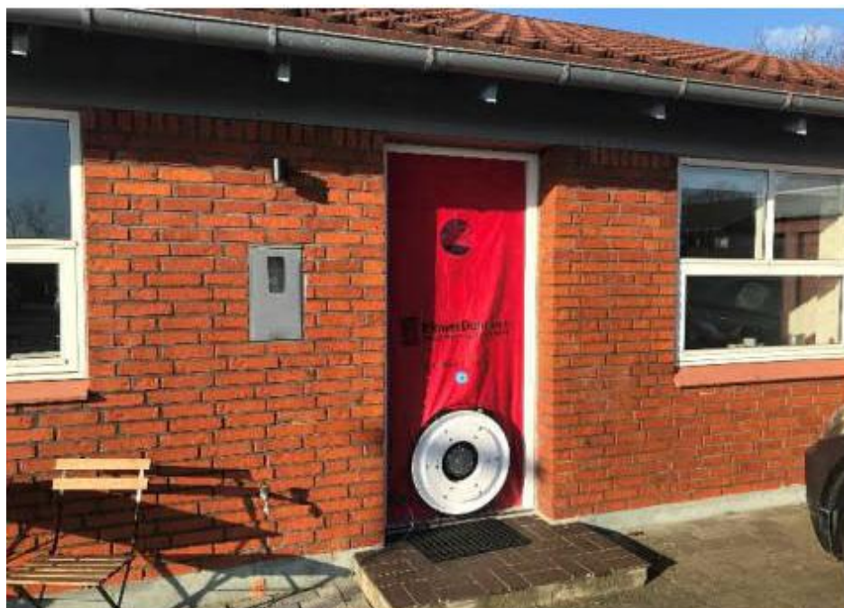
Figur 10.22: Placering af blowerdoor i hoveddør i bolig i Aalborg.
